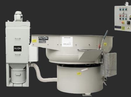
Le modèle de sécheur VBD, est équipé de résistances chauffantes destinées à chauffer les abrasifs végétaux, principalement la rafle de maïs, celle-ci permet le séchage par absorption de l'humidité des pièces en agissant comme une éponge.
