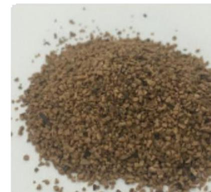
ActOn propose l'épi de maïs et la coquille de noix prétraités. L'épi de maïs prétraité a été développé pour la réalisation d'une finition miroir brillante. On peut l'utiliser dans des machines vibratoires et haute énergie. La coquille de noix donne aux composants une brillance élevée, et on a démontré que sur certaines matières, la coquille de noix prétraitée produit un lustre supérieur à celui de l'épi de maïs prétraité.
